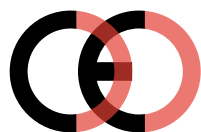
Falsk CE-mærke (for tæt på hinanden)
